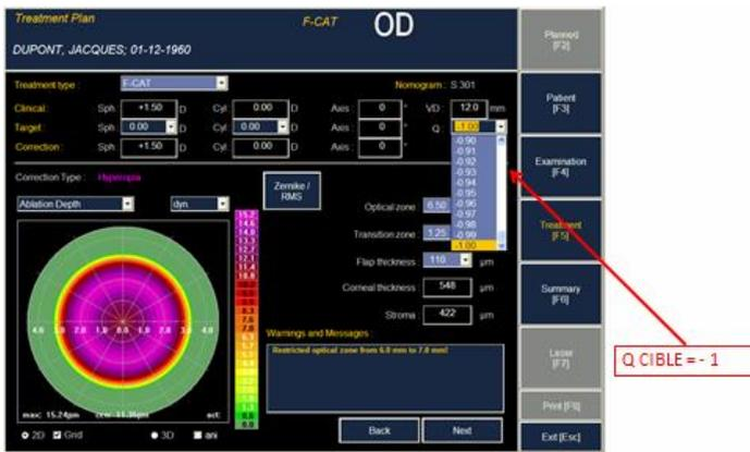
Fig 4 Programmation de la Modification du facteur Q : ici Q cible = -1 ce qui induit une modification de la photoablation dans sa partie sphérique
